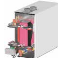
Kit intercambiador de placas Profundidad del kit 639 mm. Ida/retorno 2". Conexión gas 1" 1/2.
