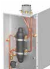
Kit botella de equilibrio Profundidad del kit 250 mm. Ida/retorno 1" 1/2. Conexión gas 1".
